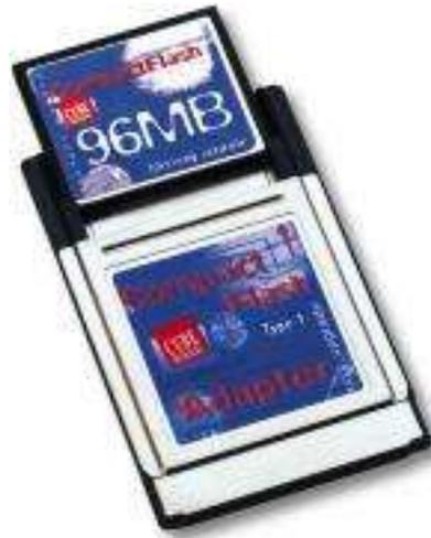
Figure 12: Carte Compact Flash dans un adaptateur PC-Card
