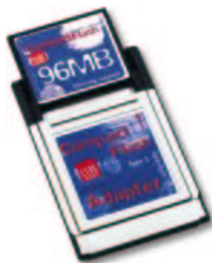
Figure 2: Adaptateur PC-Card pour CompactFlash
