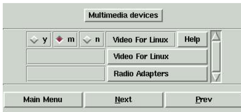
Figure 2: Validation du support V4L pour le noyau 2.4
