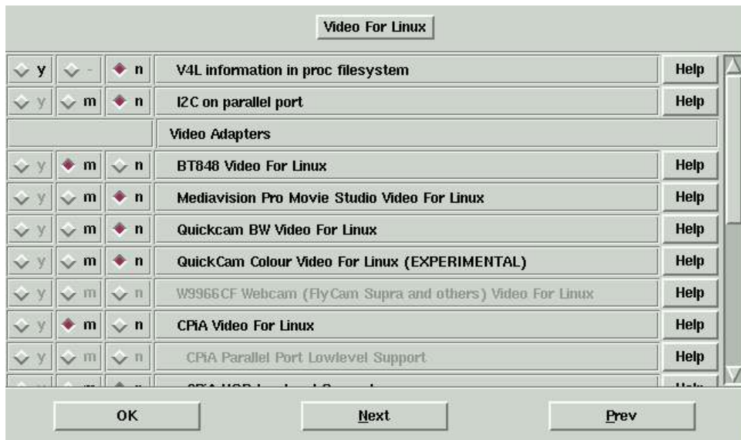
Figure 3: Sélection des périphériques V4L pour le noyau 2.4
